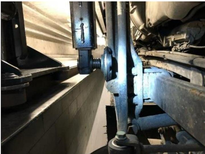
Weitere erhebliche und verkehrsfährdende Mängel schließen sich an: Die Beleuchtung ist teilweise defekt oder fehlt. Ein Tankverschluss ist nicht vorhanden, der Behälter ist lediglich mit einer Folie abgedeckt. Bei Lenkbewegungen gibt es laute, knackende Geräusche im Bereich der Vorderachse.
